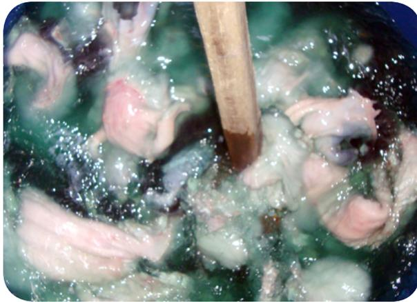
**Figura 3.7.** Pieles en solución curtiente y agitado con palo de madera
