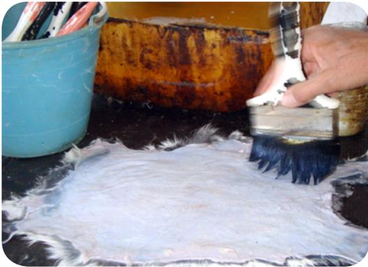
**Figura 4.5.** Engrasado del cuero utilizando mezcla Paraná
