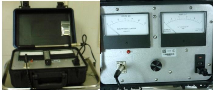
Fig 11 Electroeyaculador de voltaje regulado
