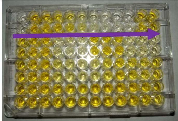
Fig1. Placa de ELISA competitivo, sobre la flecha se observa la curva de calibración (9 puntos), de cómo el color inicialmente es más intenso y se atenúa hacia el lado derecho, donde la concentración de la curva va aumentando.
