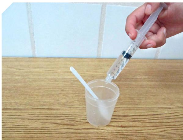
**Figura 43.** Agregando agua destilada a la muestra.
