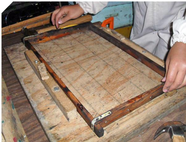
**Figura 54.** Alambrado de bastidores.
