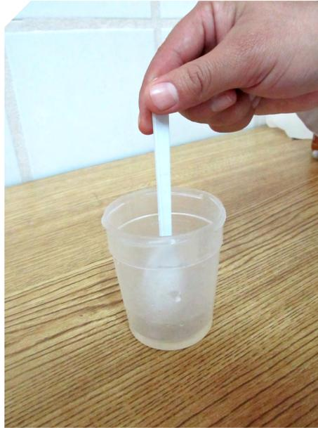
**Figura 44.** Disolviendo la muestra en agua destilada.
