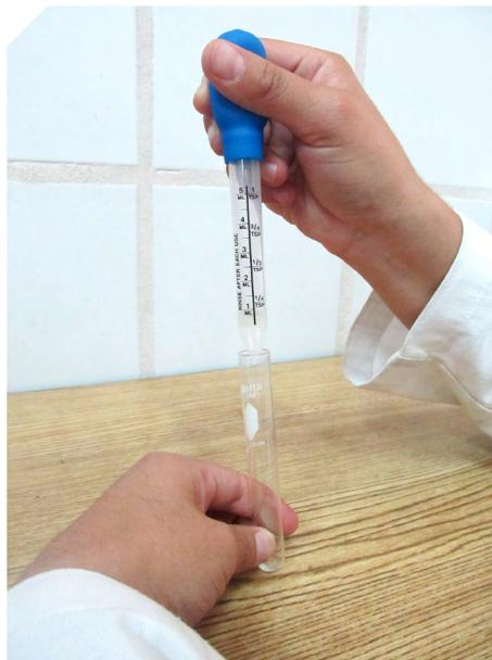
**Figura 45.** Pasando una parte de la dilución a un tubo de ensayo.
