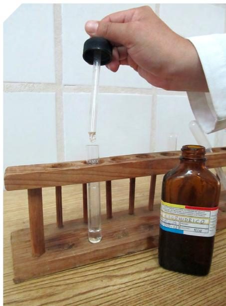
**Figura 46.** Agregando ácido clorhídrico concentrado.
